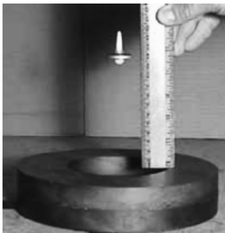
Figuur 1 Het Levitron: levitatie van een draaiend magneetje in een magnetisch veld
