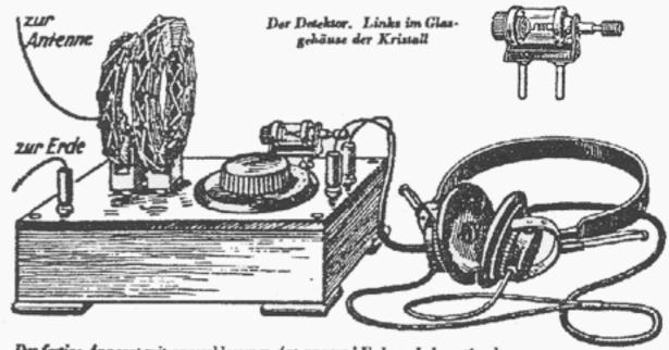
Der fertige Apparat mit angeschlassener Antenne und Erde und eingestöpseltem Kopf hörer
